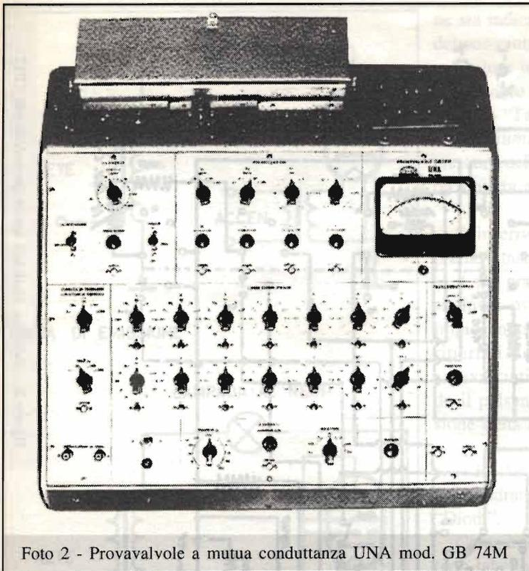
Foto 2 - Provalvalvole a mutua conduttanza UNA mod. GB 74M
